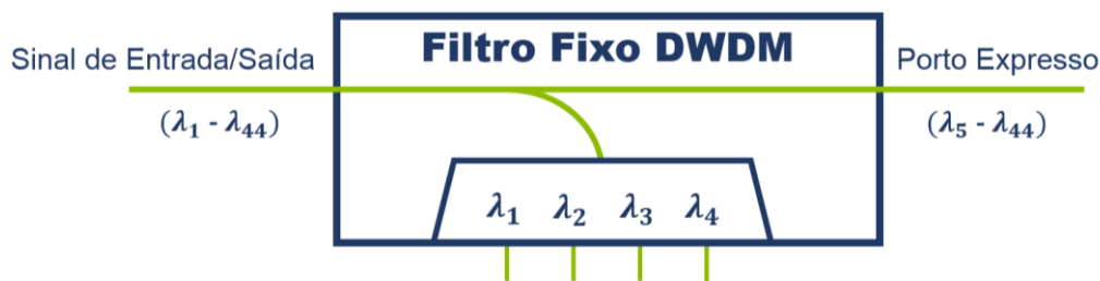
Figura 2.3 – Estrutura de um filtro fixo pluggable DWDM de 4 canais
